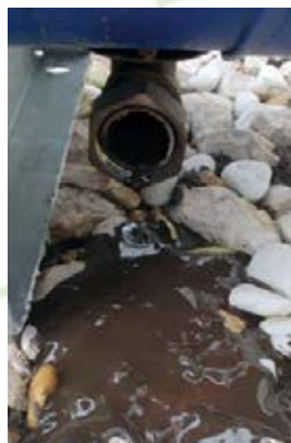
Rézcsővel „kötött” acéltartály csatlakozóinak elektrokémiai korróziója 16 hónap üzemeltetés után, a csatlakozók hegesztési varratainál már első üzemében belül szivárgást okozhat.
