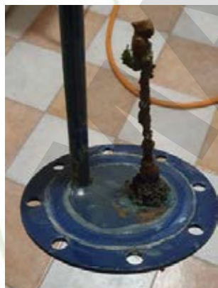
Elektrokémiai korrózió egyik következménye a gyors anódfogyás, ezért indokolt az első anódcseré 12 hónaponál, így annak jelentős fogyása esetén még idejében feltárható a probléma a tároló test sérülése nélkül (azt követően 18 hónap).
