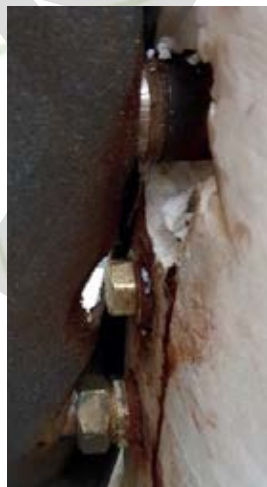
Rézcsővel „kötött” acéltartály csatlakozóinak elektrokémiai korróziója 16 hónap üzemeltetés után, a csatlakozók hegesztési varratainál már első üzemében belül szivárgást okozhat.
